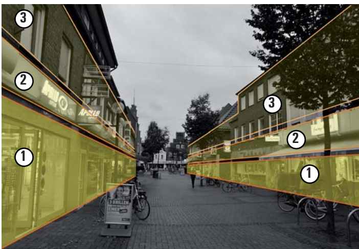
Prinzipiskizze, Zonierung der Beleuchtungsebenen
