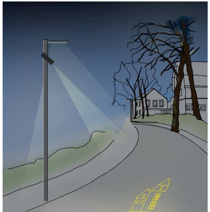
Goboprojektion am Verbindungsweg: Montage an Mast Funktionalbeleuchtung
